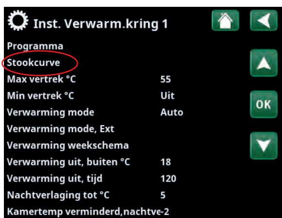
Onderdeel van het menu: "Installateur/Instellingen/Verwarmingskring/Verwarmingskring 1".
