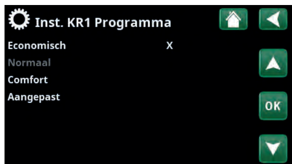
Menu "Installateur/Instellingen/Verwarmingskring/Verwarmingskring 1/Programma".
