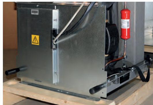
7. Til de koelmodule in het product met de draaggrepen en de schouderbanden. Verwijder de draaggrepen en sluit de voedingskabel en de slangen weer aan en bevestig de schroeven.
