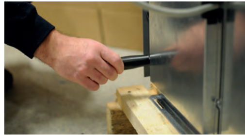
2. Bevestig de twee draaggrepen aan de onderkant van de koelmodule.
