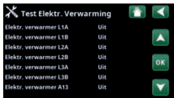
Menu: "Installateur/Service/Functietest/Elektrische weerstand".
