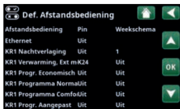
Onderdeel van het menu "Installateur/Definieer/Afstandsbediening".
