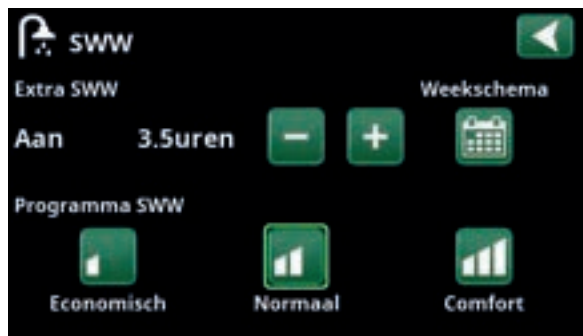
De functie "Extra SWW" is ingesteld om 3,5 uur actief te zijn.
