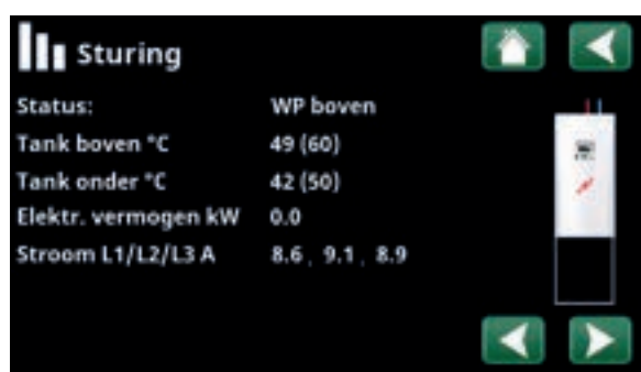
Menu: "Werkingsdata/Sturing". Klik op de pijlen of veeg om te wisselen tussen de bedieningseenheid en de warmtepomp.
