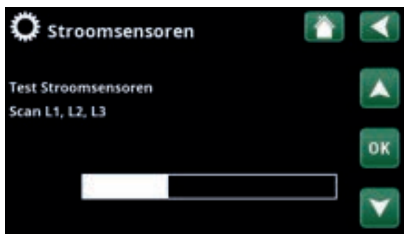
Menu: "Installateur/Instellingen/Stroomsensoren /Auto config. stroomsensor".
