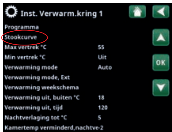
Onderdeel van het menu: "Installateur/Instellingen/Verwarmingskring/Verwarmingskring 1".
