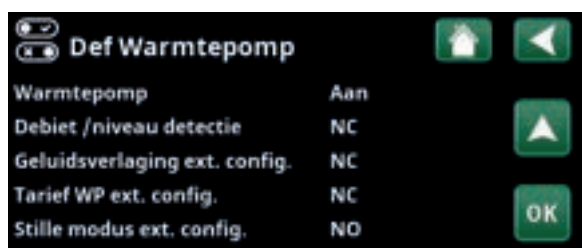
Menu: "Installateur/Definieer/Warmtepomp". Een modus voor het externe regelsignaal ("Normaal open (NO)" of "Normaal dicht (NC)") wordt opgegeven voor "Tarief WP ext. config."
