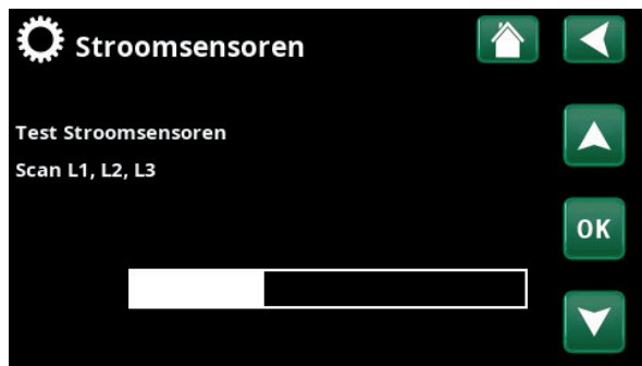
Menu: "Installateur/Instellingen/Stroomsensoren /Auto config. stroomsensor".
