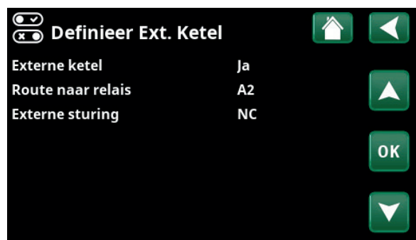
Menu: "Installateur/Definieer/Externe Ketel".
