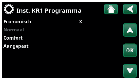
Menu "Installateur/Instellingen/Verwarmingskring/Verwarmingskring 1/Programma".
