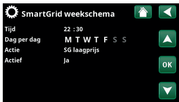
De SmartGrid functie "SG Laagprijs" is gepland op weekdays van 22:30-06:00. Ga naar het menu door 'SmartGrid wekelijks programma' te selecteren in het menu "Installateur/Instellingen".
